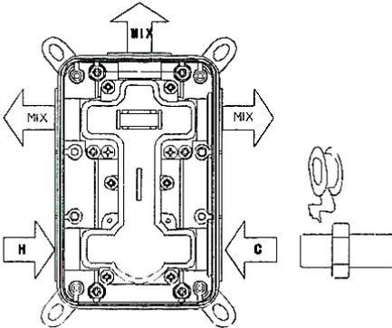
4. Envolve a tubagem de entrada de água em Teflon para assegurar uma vedação estanque e conecte com a entrada de água G1/2 da caixa.
