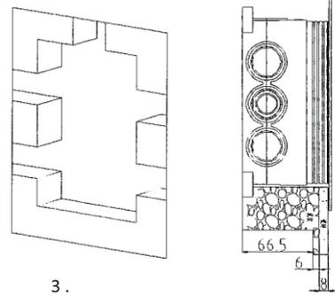
3. O encaixe para a caixa na parede deverá ter a profundidade de 66,5mm, estando a parede a cru.
