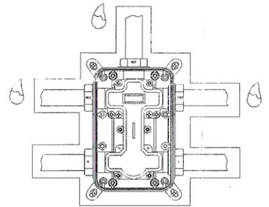
6. Ligue a água na conduta principal, escoe os detritos e verifique se existem fugas. Proceda às restantes ligações com Teflon.
