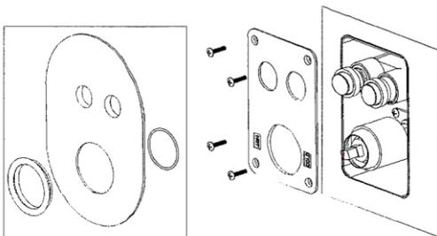
11. Volte a colocar a tampa e instale a frente em aço inox com o O ring. A frente em aço inox deverá encostar ao revestimento.
