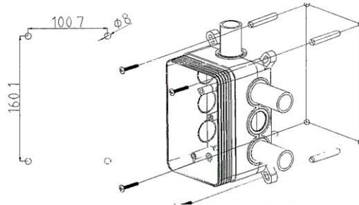
5. Coloque a caixa na parede, verifique se a mesma se encontra nivelada. Faça 4 furos de 8mm, coloque as buchas e fixe com parafusos.
