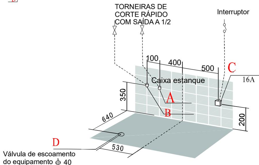
**Nota 1: O Tubo de esgoto deve ficar nas proximidades da válvula de escoamento do equipamento, num raio de 100200m m, nunca no mesmo ponto.**
