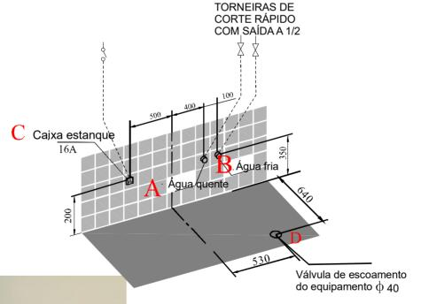
Nota 1: O Tubo de esgoto deve ficar nas proximidades da válvula de escoamento do equipamento, num raio de 100200m m, nunca no mesmo ponto.
